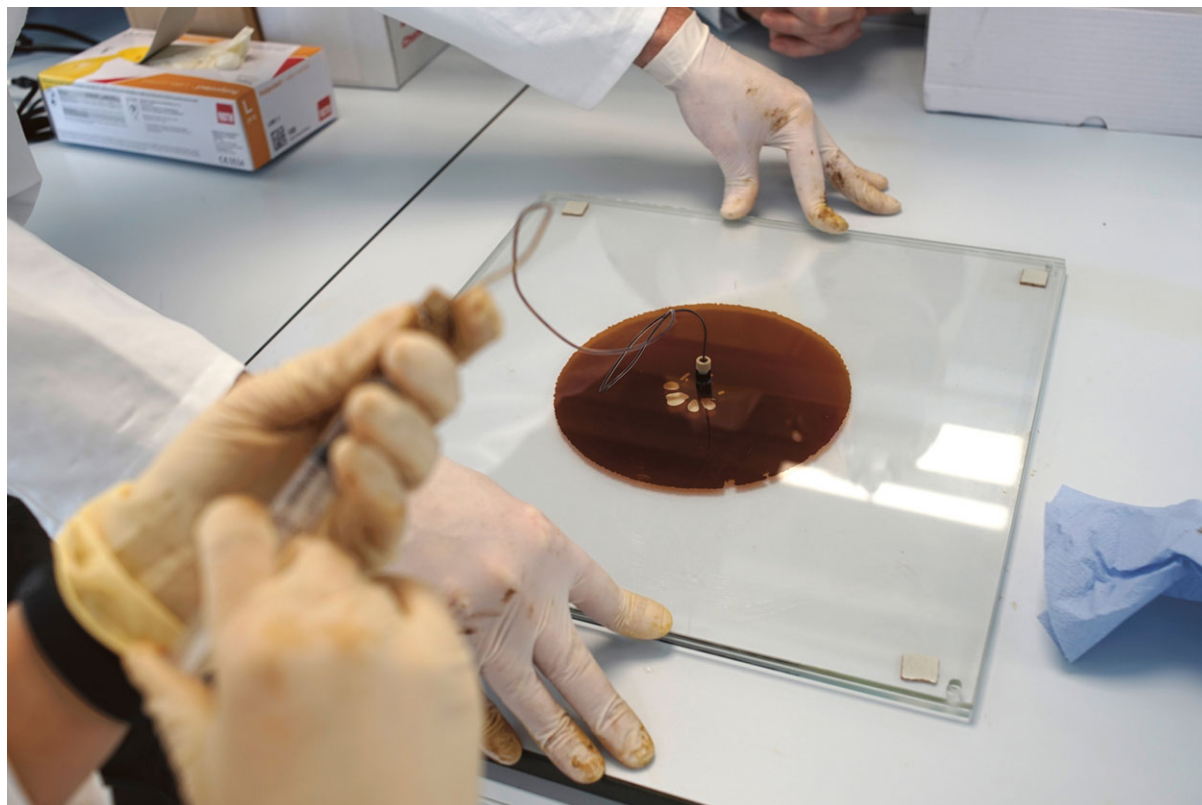
Das wissenschaftliche Hele-Shaw-Zell-Experiment zeigt, wie sich Wasser, das über die Spritze eingeleitet wird, mit dem zähflüssigen Öl vermischt. Quelle: Ernst Logar
